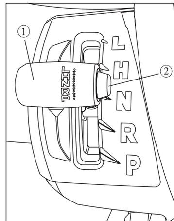
Для переключения из положения «N» в режим «H» или «R», из «L» в «H» или из «P» в «R» необходимо нажать на кнопку ②. Для переключения из режима «H» в «L» или «N», из «R», в «N» или «P» не нужно нажимать на кнопку ②. При переключении между режимами «N», «R» и «P» необходимо нажать на ножной тормоз.
