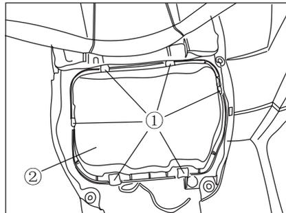
1. Снимите сиденье и удалите облицовку корпуса воздушного фильтра.
