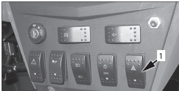
1. Выключатель аварийной сигнализации
