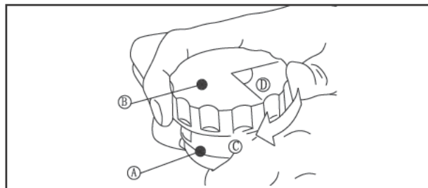
А—компенсационный бачок; В—крышка бачка; С—по часовой стрелке; D—1/16 часть окружности
