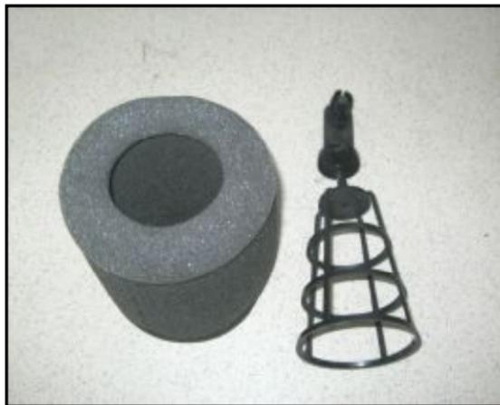
3. Снимите элемент воздушного фильтра в сборе.
