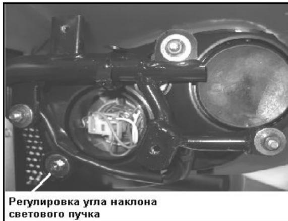
Регулировка угла наклона светового пучка
