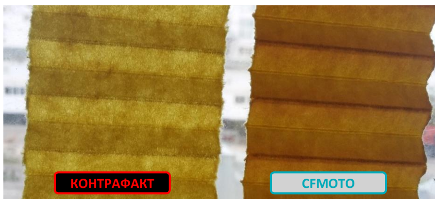
Материал оригинального фильтрующего элемента (справа) имеет более высокую плотность и толщину
