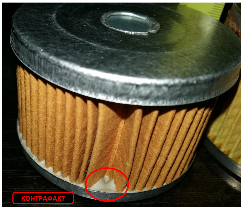
Неравномерная проклейка фильтрующего элемента
