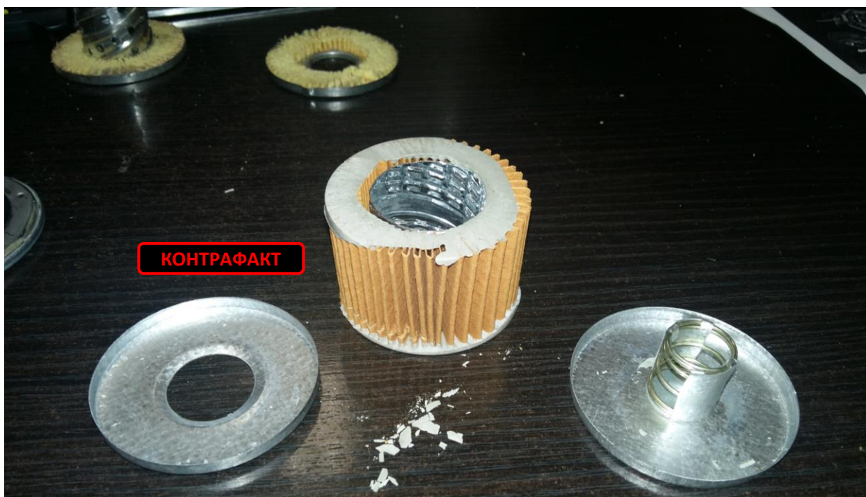
Низкокачественная прокладка неоригинального фильтрующего элемента. На заднем плане видны спиленные крышки оригинального фильтра.
