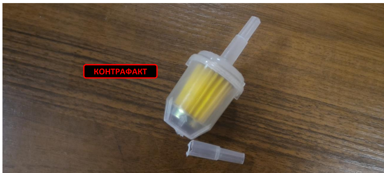
Корпус неоригинального топливного фильтра изготовлен из хрупкой низкокачественной пластмассы
