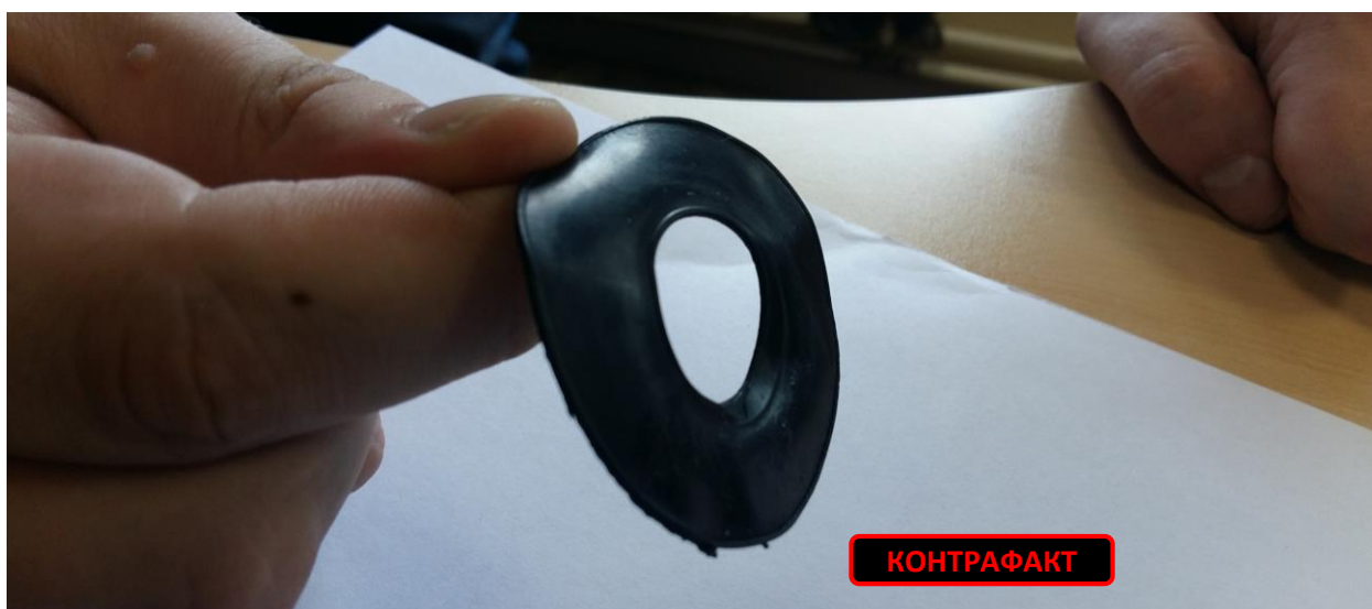
Антидренажный «клапан» неоригинального фильтра
