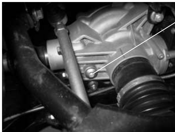
1) Болт заливного отверстия переднего редуктора
