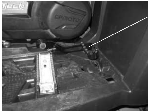
б) Педаль главного тормозного цилиндра
