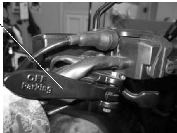
5) Рычаг парковочного тормоза (в левом положении «OFF Parking»)
