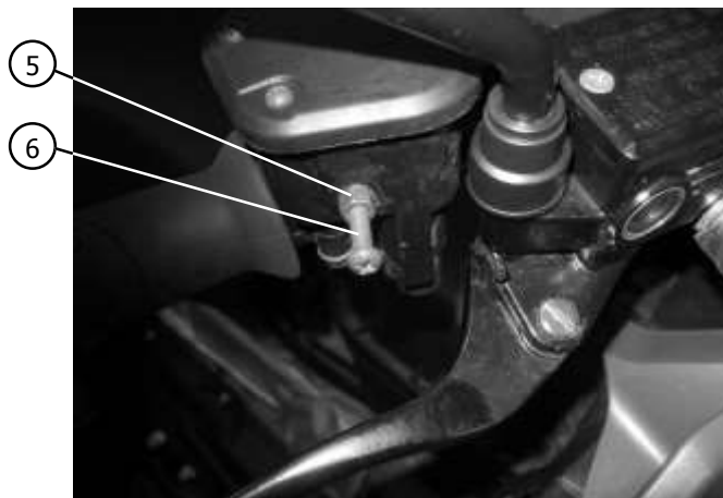
5) Контргайка винта регулировки курка газа
