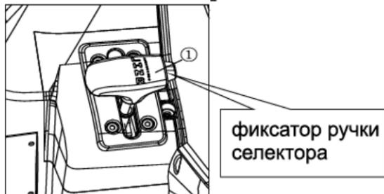
Для включения режима "H" "L" или "R" необходимо нажать на ножной тормоз или выжать его дублирующий рычаг, утопить фиксатор ручки селектора и, удерживая его, перевести ручку в требуемую позицию.
