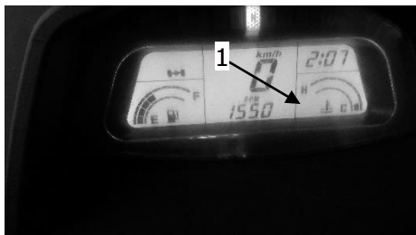
1 – Не горящая индикация «EPS» при запущенном двигателе
