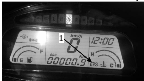
1 – Горящая индикация «EPS» при не запущенном двигателе
