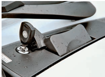
➡️ Запираются боковые кофры трижды: замки с небольшими ручками дополнены парой защелок с каждой стороны. Перестраховываются? Возможно, но внезапно такой «сим-сим» точно не откроется. Жаль, что быстрого съема пары боковых чемоданов не предусмотрено...
