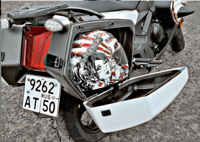
➡️ Запираются боковые кофры трижды: замки с небольшими ручками дополнены парой защелок с каждой стороны. Перестраховываются? Возможно, но внезапно такой «сим-сим» точно не откроется. Жаль, что быстрого съема пары боковых чемоданов не предусмотрено...
