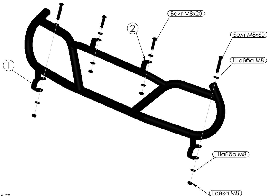
1. Навесить силовой бампер с помощью ушей крепления (Поз.1) на раму квадроцикла.
