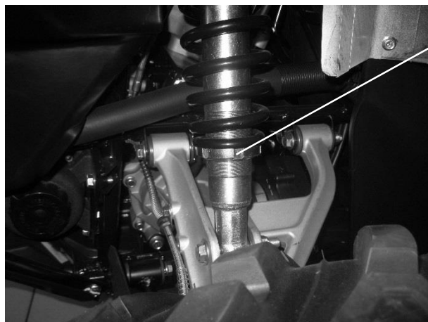
1) Гайка регулировки предварительного натяжения пружины
