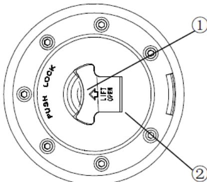
1. Крышка замочной скважины    2. Крышка топливного бака
