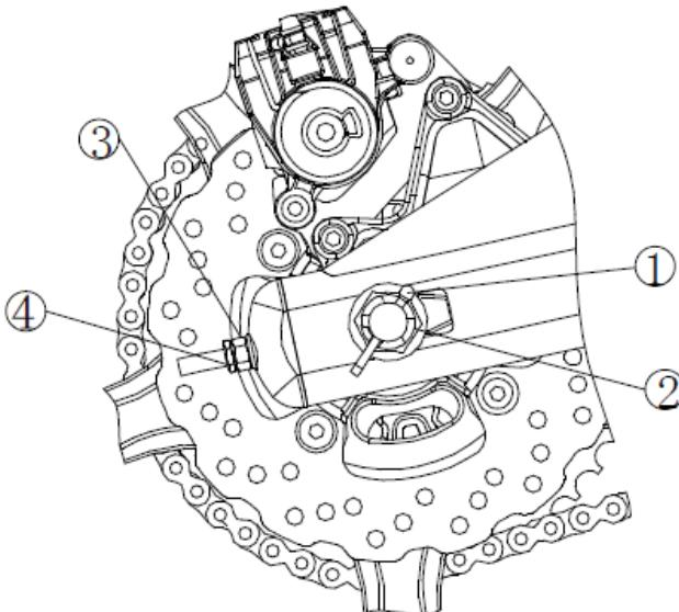
1. Шплинт 2. Гайка крепления оси
