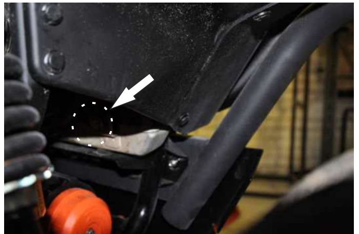
Открутите правый нижний болт крепления вентилятора
