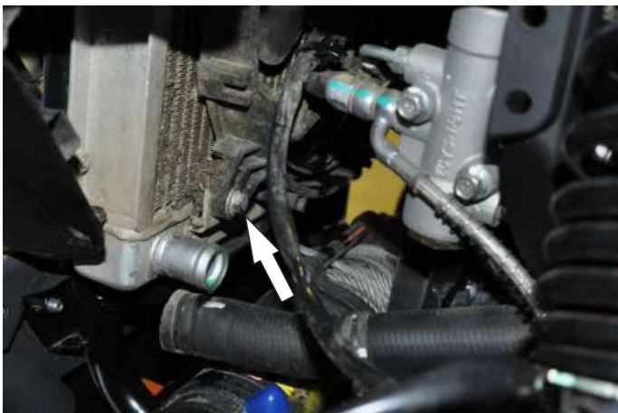
Открутите левый нижний болт крепления вентилятора
