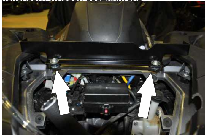
Установите кронштейн, используйте болты М8 из установочного комплекта
