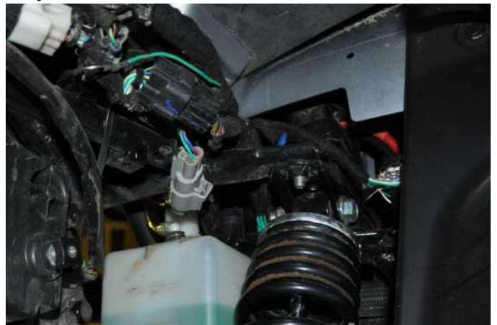
Подключите клемму вентилятора
