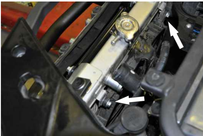
Открутите верхние болты крепления вентилятора
