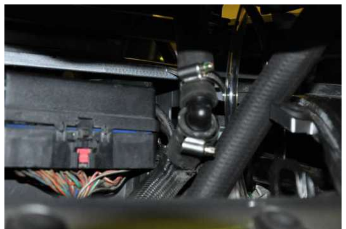
Установите угловой соединитель между верхним патрубком и Г-образным рукавом из установочного комплекта
