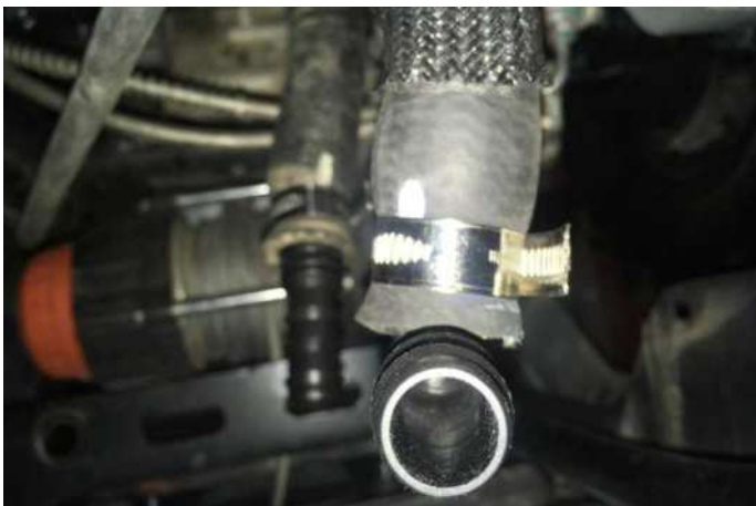
Установите угловой соединитель между нижним патрубком и прямым шлангом из установочного комплекта
