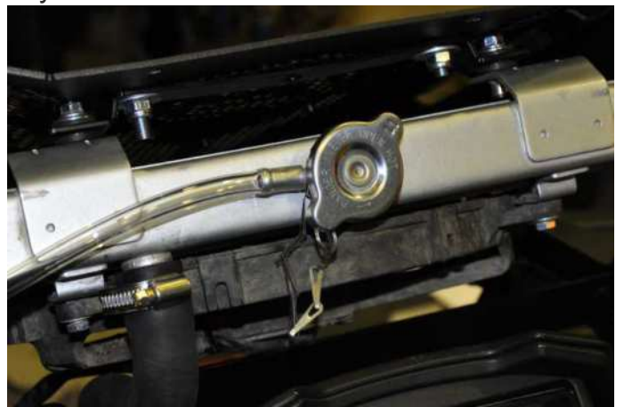
Закрепите радиатор на корпусе выноса, используя кронштейн из установочного комплекта
