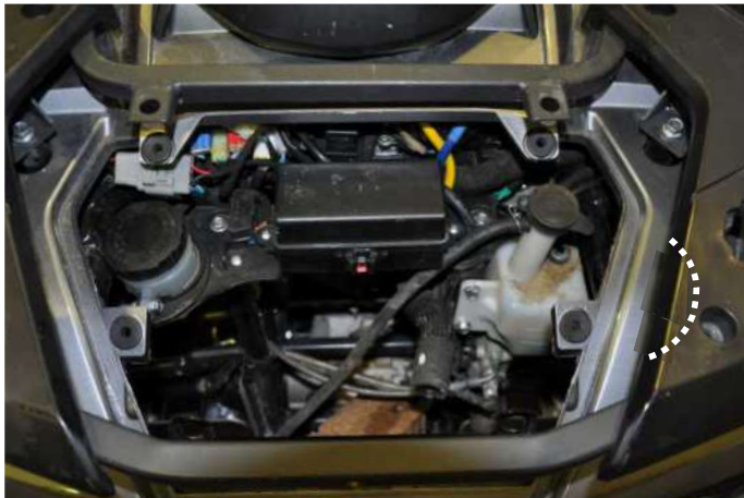
Установите блок предохранителей, бачок тормозной жидкости и расширительный бачок
