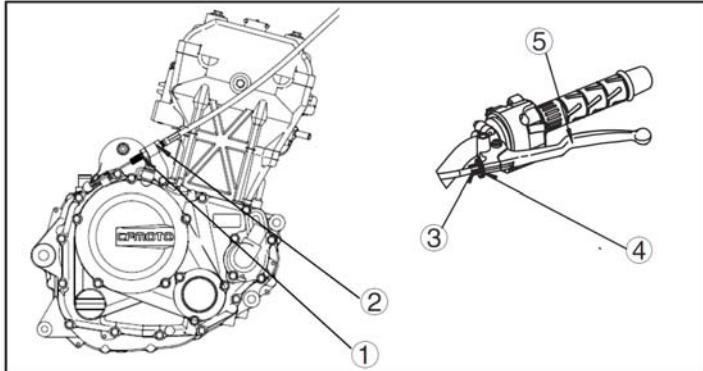
1. Стопорная гайка; 2. Регулировочная гайка;
