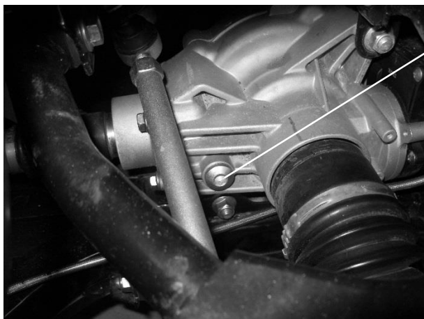
1) Болт заливного отверстия переднего редуктора
