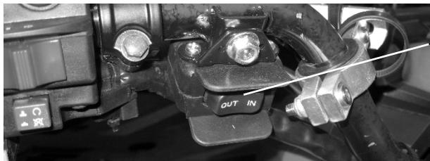
Данная модель техники может быть оборудована лебедкой. Оснащенная лебедкой техника имеет следующее дополнительное оборудование: лебедка (мотор и редуктор), кнопка управления лебедкой, тросоукладчик, проводка.
