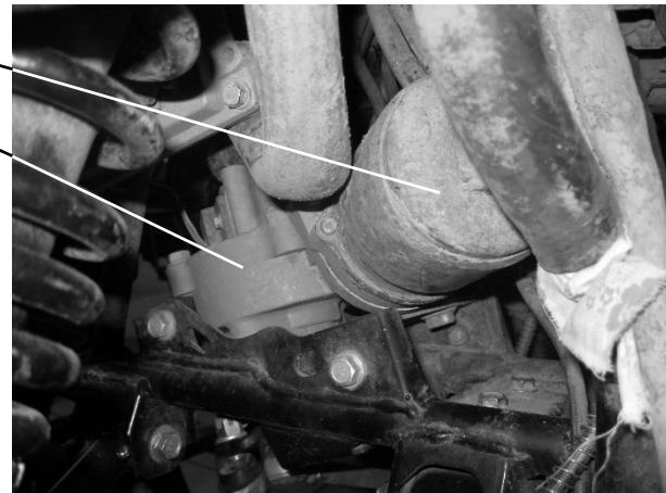
1) Мотор электрического усилителя руля
