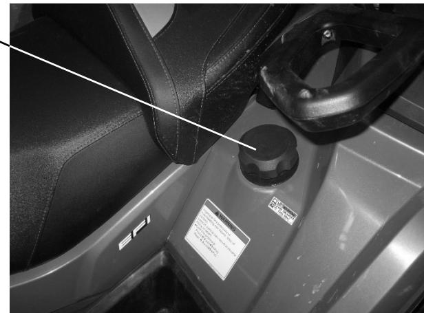
1) Крышка топливного бака
