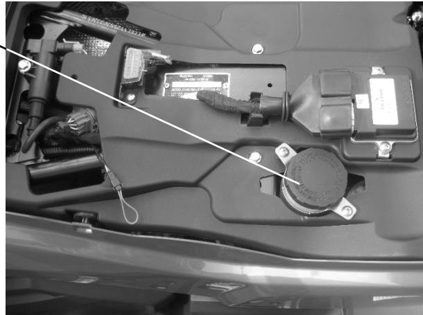
7) Расширительный бачок тормозной системы
