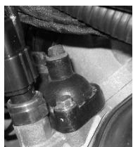
**Прежде чем приступить к заливке охлаждающей жидкости, частично выкрутите болт на средней части крышки терmostата, это позволит избежать образования воздушных пробок в системе охлаждения. Когда из-под болта польется охлаждающая жидкость без пузырьков воздуха закрутите болт обратно. Используйте готовый этиленгликолевый антифриз высокого качества для алюминиевых двигателей, который содержит антикоррозионные присадки.**
