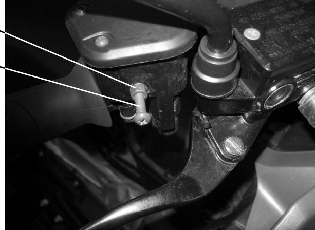
5) Контргайка винта регулировки курса газа
