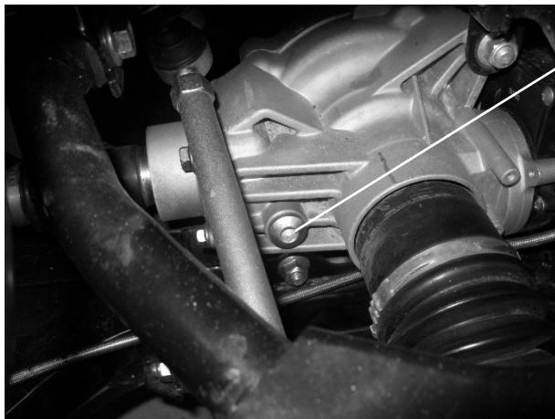
1) Болт заливного отверстия переднего редуктора
