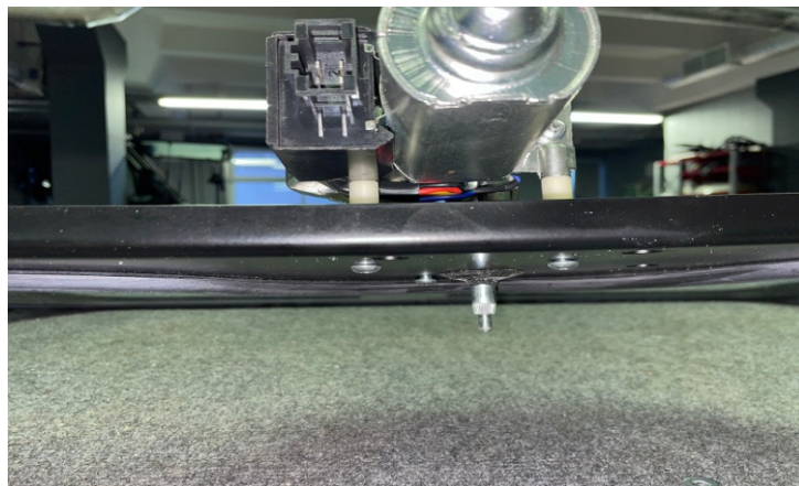
Закрепить мотор стеклоочистителя
