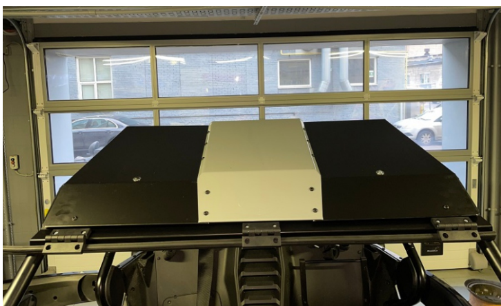
Установите алюминиевую крышу на каркас
