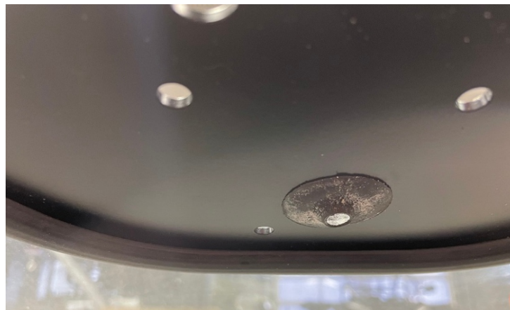
Установить уплотнение мотора стеклоочистителя
