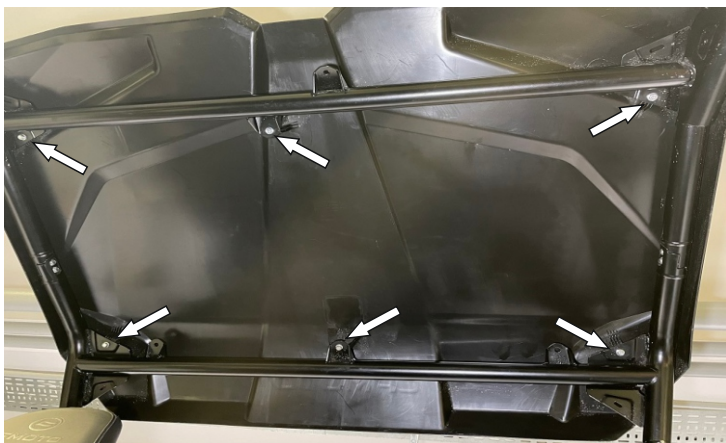
Снимите штатную пластиковую крышу
