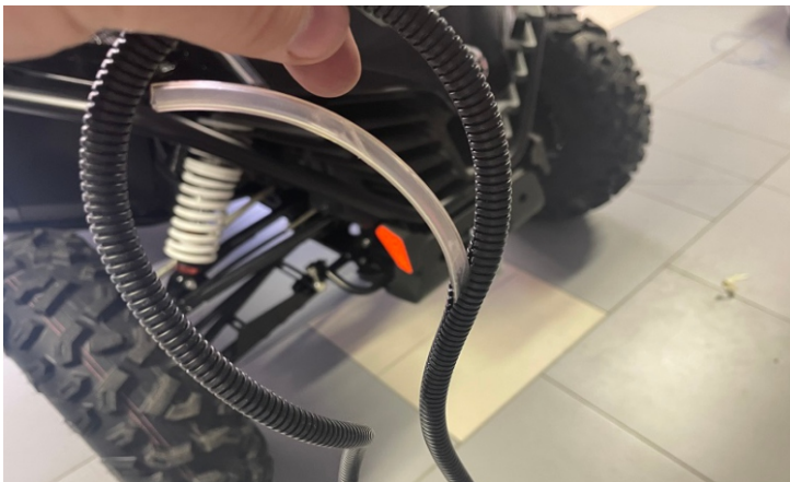
Продеть трубку стеклоомывателя в гофру
