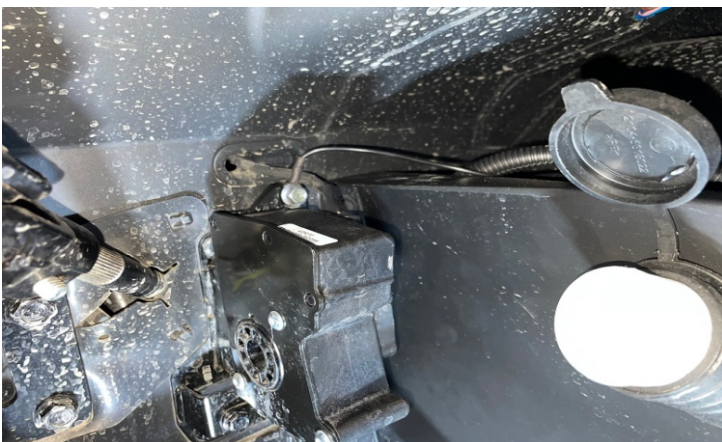
Подключить отрицательную клемму (черный) к кронштейну педали как на показано на фото.
