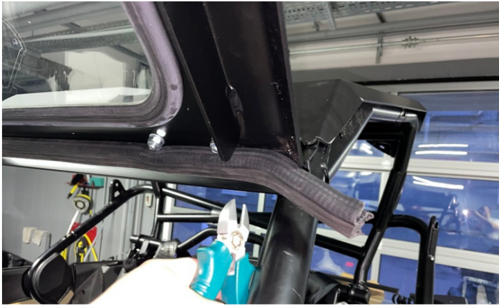
Установить уплотнитель на рамку, как показано. Излишки отрезать.
