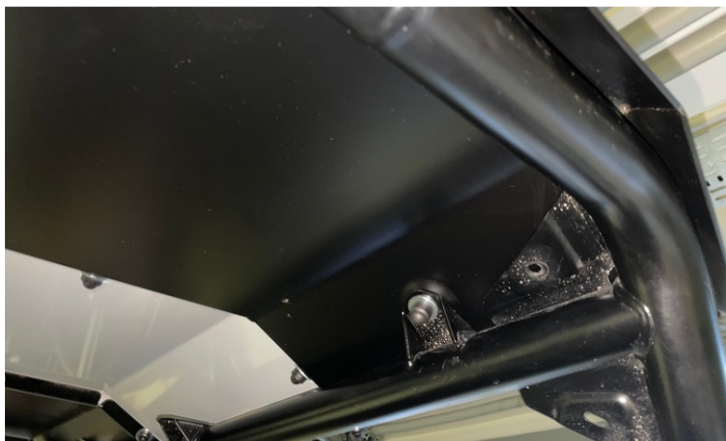
Наживите крепеж крыши к задней части каркаса
