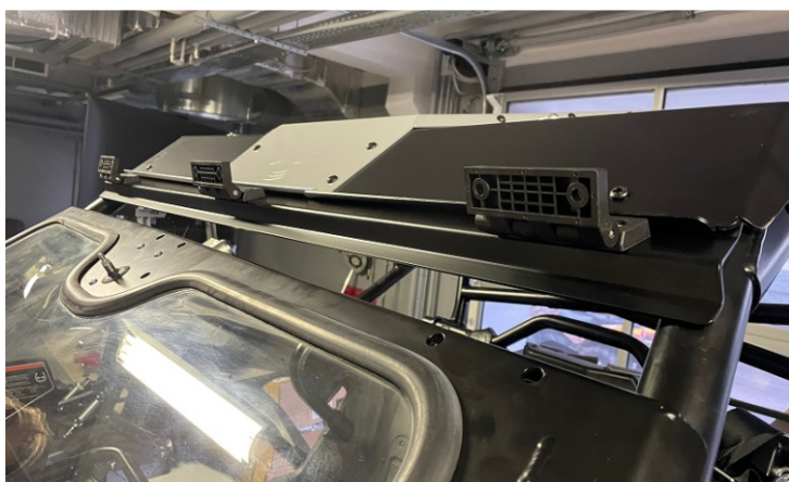
Приложить рамку на переднюю часть каркаса
