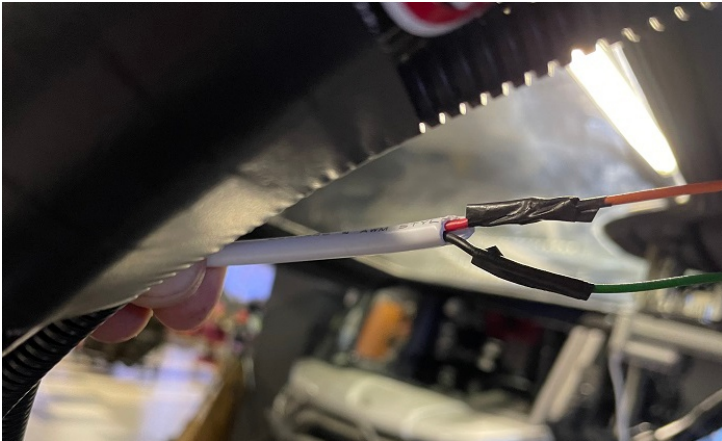
Соединить проводку актуатора и электропроводки подъемного стекла. Изолировать соединение.
