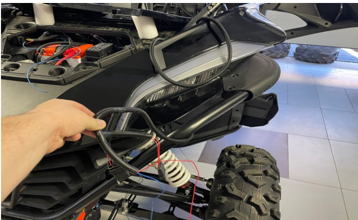
Протянуть электрическую проводку подъемного стекла от панели кнопок под крышей до подкапотного пространства.
