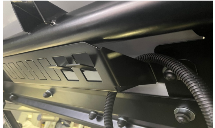
Удалить заглушки 2-х кнопок в панели под крышей.
