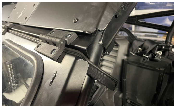
Постепенно затянуть крепеж петель, приподнимая и опуская рамку (петли выровняются между собой)
