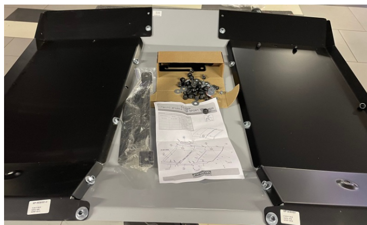
Наживите весь крепеж в отверстиях, согласно схеме.
