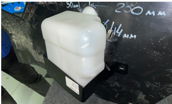
Установить бачок омывателя, прижав его к плоскости как показано на фото
