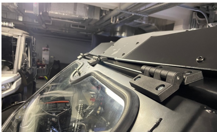
Наживить сначала крайние петли, затем центральную
