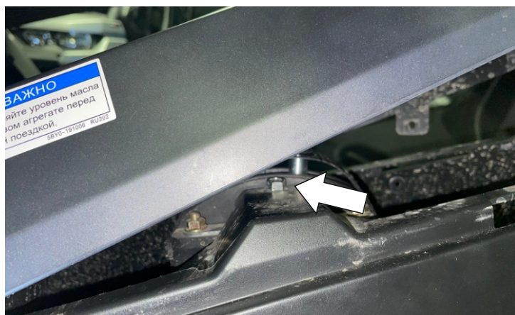
Открутить болт крепления панели водителя
