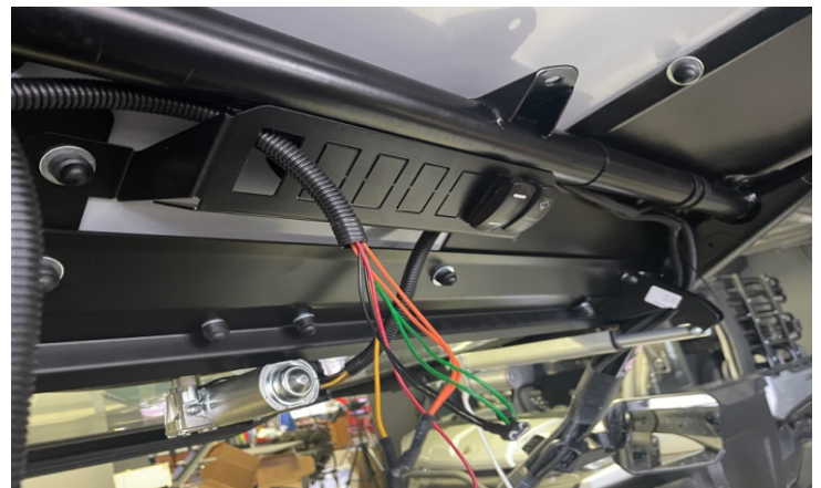
Протянуть конец электрической проводки через панель.
