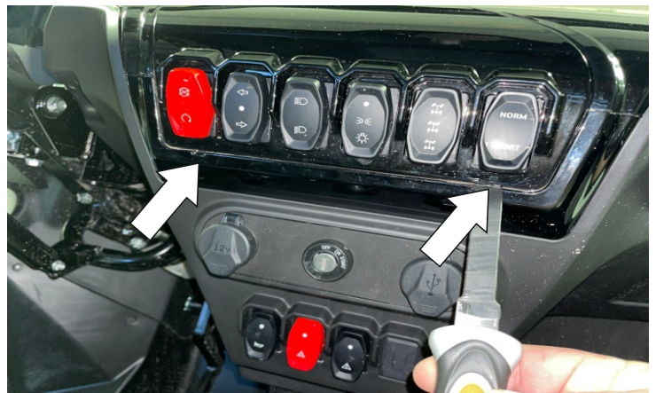
Съемником поддеть снизу центральную панель с кнопками
