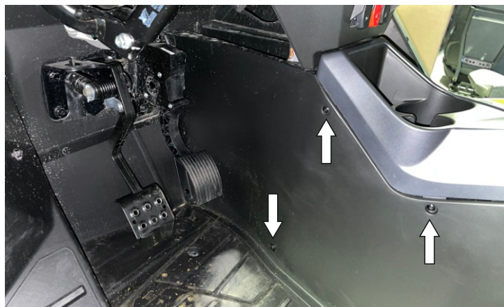
Снимите крепеж боковой панели ног водителя
