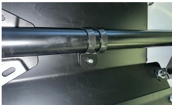
Наживите крепеж крыши и хомутов
