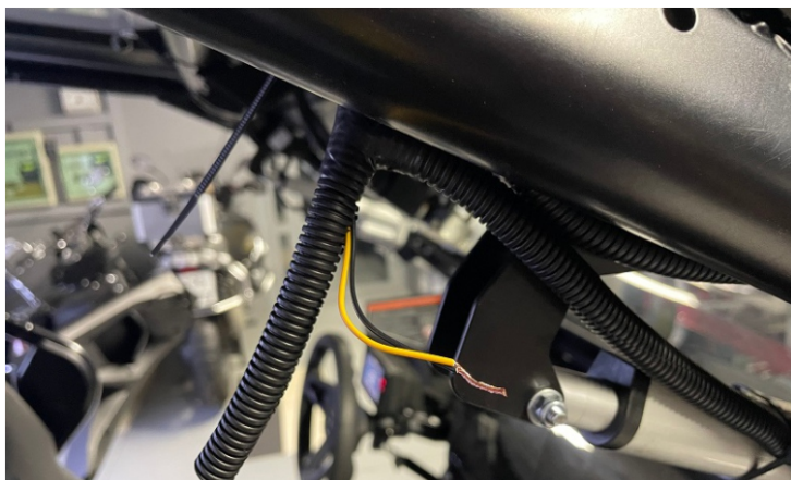
Соединить провода между собой. Изолировать соединение
