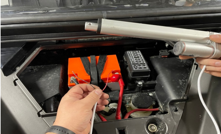
Подать напряжение на контакты линейного актуатора. Полностью сжать. Актуатор отключится автоматически.
