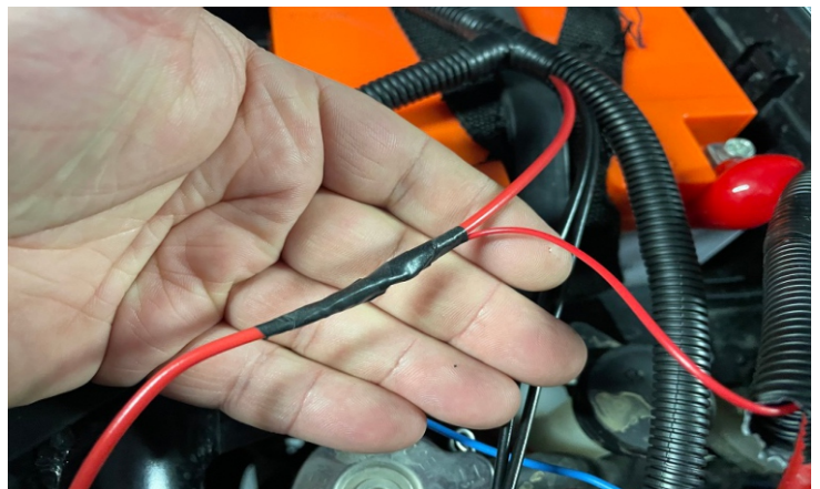
Подключить проводку подъемного стекла к проводке стеклоочистителя. Место соединения изолировать.
