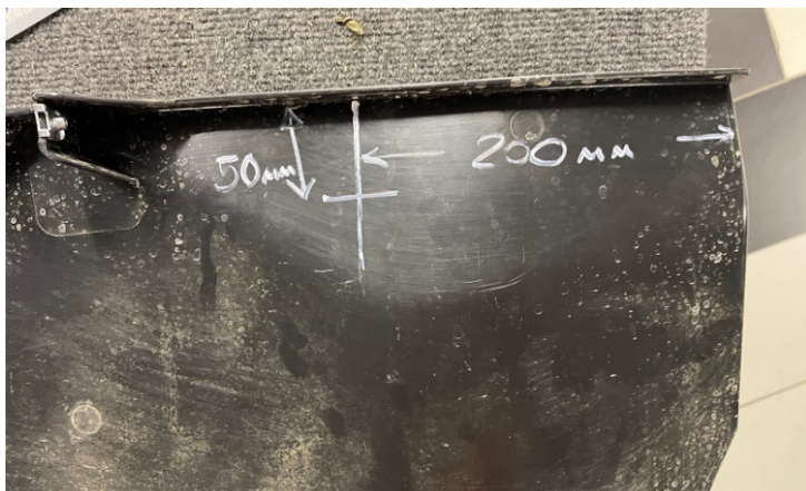
Разметить место отверстия как показано на фото
