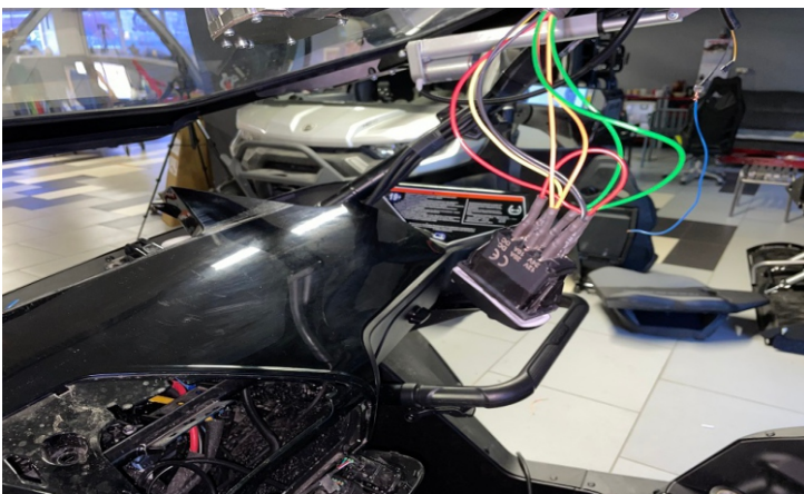
Подключить тумблер к электропроводке. Установить тумблер на панель кнопок под крышей
