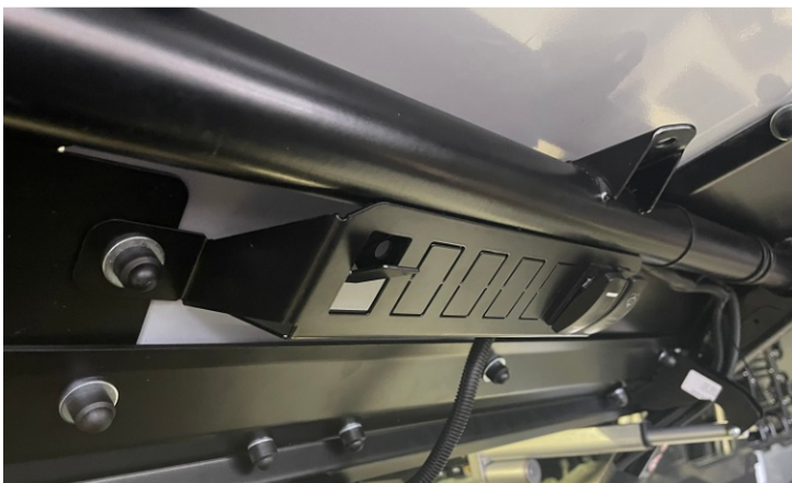
Удалить заглушку одной кнопки в панели под крышей.
