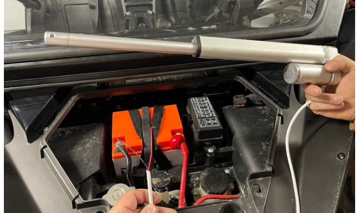
Подать напряжение на противоположные контакты линейного актуатора. Полностью разжать, отключится автоматически.
