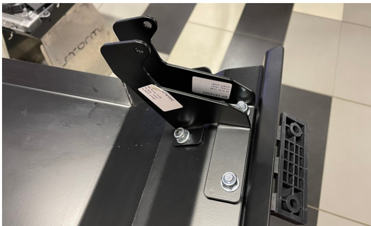
Установить внутреннюю часть кронштейна. Закрутите крепеж.
