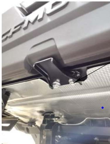
1. Выкрутить 2 штатных болта и снять металлический кронштейн
