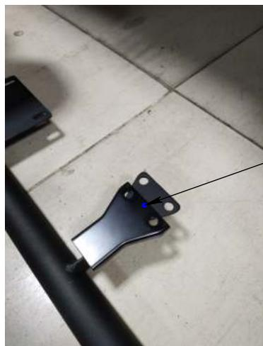
3. Бампер устанавливать, используя ранее снятый кронштейн в п.1, в качестве проставки
