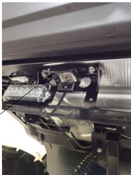
2. Снять кронштейн крепления рамки номерного знака
