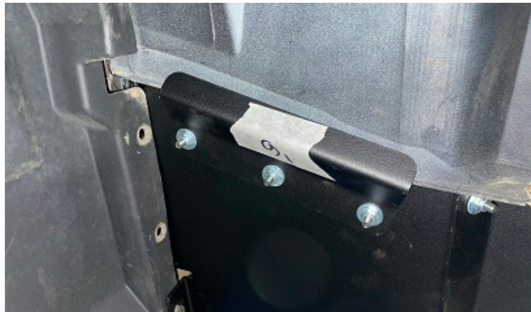
Закрепить штатное заднее крыло между панелями №2 и №9.
