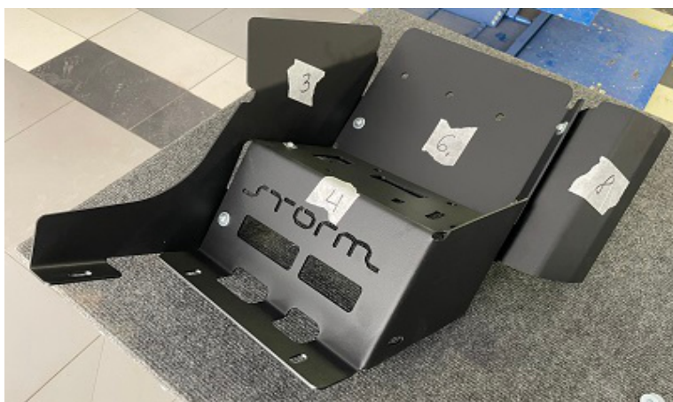
Собрать узел (опора ног пассажира) как показано. Наживить крепежом.
