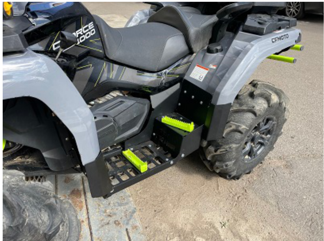
Закрепить штатное заднее крыло между панелями №6 и №9.
