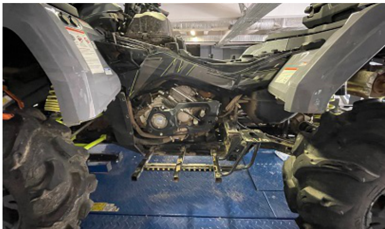
Снять штатную пластиковую подножку. Установить на место боковую панель и накладку кулисы.
