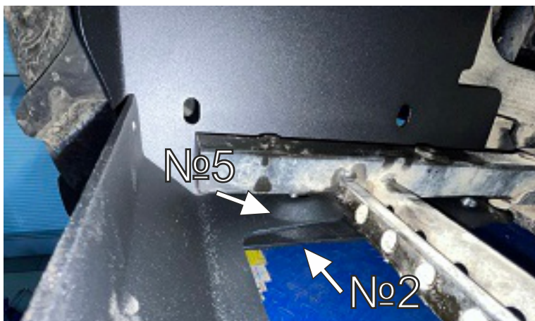
Отверстие боковой панели №5 установить над передней панелью №2. Наживить винтом.
