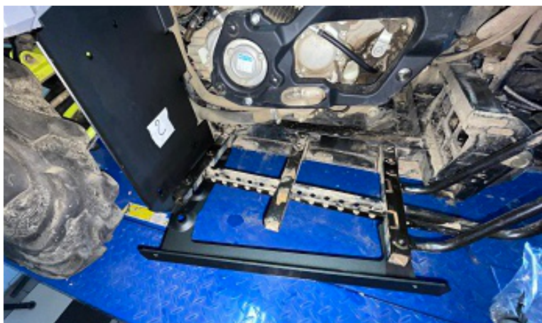
Совместить отверстия боковой панели №5 и передней панели №2.
