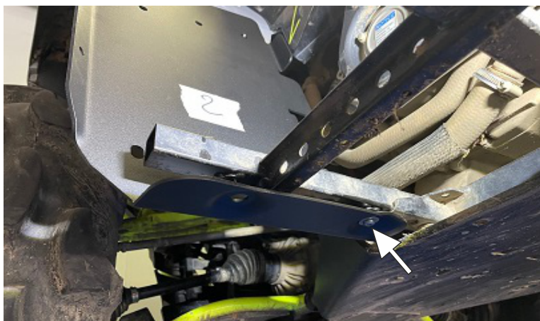
Установить и наживить переднюю панель №2 винтом снизу.
