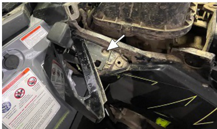
Снять накладку кулисы (вверх). Открутить болт боковой панели
