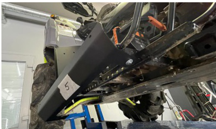
Установить и наживить боковую накладку №5 винтом снизу.
