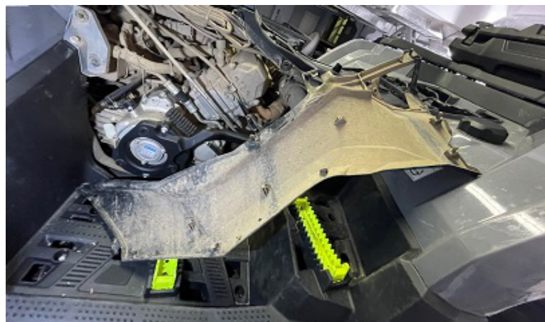
Снять боковую панель (переднюю часть «на себя»)
