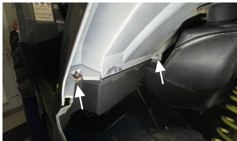
Открутить болты крепления штатной пластиковой подножки и заднего крыла
