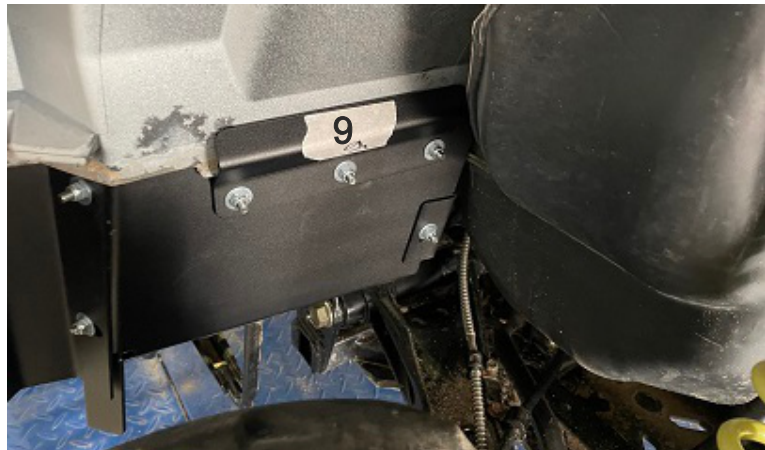
Закрепить штатное заднее крыло между панелями №6 и №9.
