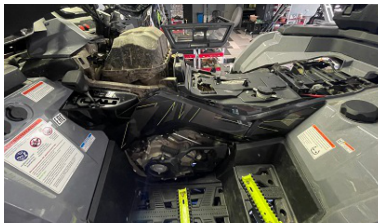
Снять сидения пассажира и водителя. Снять панель воздушного фильтра
