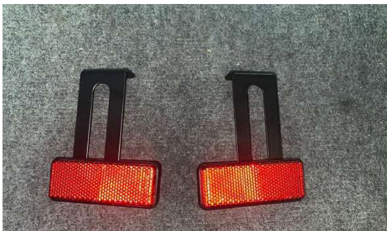
Заменить штатные кронштейны катафота на вложенные. Установить на штатное место сзади.
