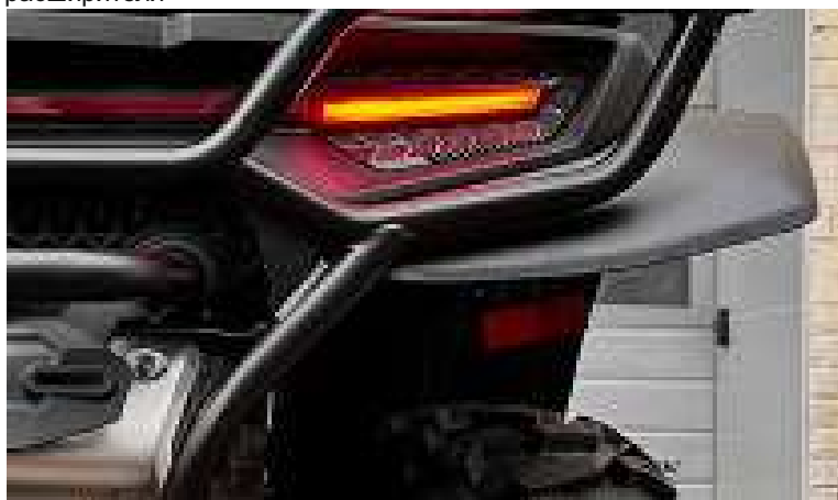
Выбрать середину расстояния между указанными клипсами, а также отступить 10мм от края штатного пластика - сделать точку крепления расширителя
