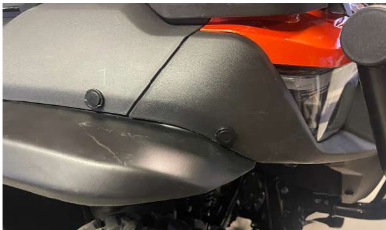
Соединить расширитель и брызговик пластиковой клипсой.
