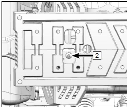
**ПРИМЕЧАНИЕ:** Избегайте попадания посторонних предметов в заливное отверстие заднего редуктора.
