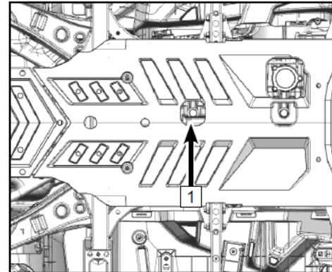
**Момент затяжки сливной пробки: 25 Н·м.**
