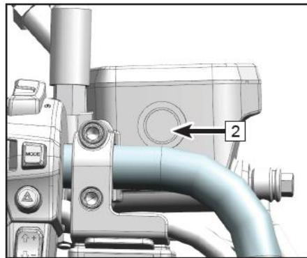
Не превышайте максимально допустимый уровень тормозной жидкости, так как это может привести к частичной или полной блокировке тормозной системы и, как следствие, серьезным травмам или гибели. Поддерживайте уровень тормозной жидкости в рекомендованном диапазоне.
