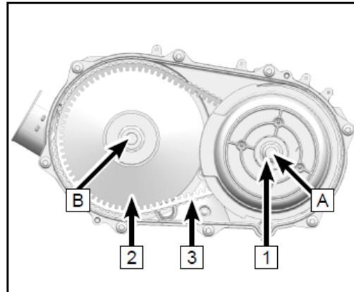
Шкивы и ремень находятся в корпусе вариатора и закрываются крышкой вариатора. Впускной и выпускной воздуховоды служат для охлаждения деталей вариатора, и их необходимо регулярно проверять. Техническое обслуживание всех элементов вариатора должно осуществляться авторизованным дилером.
