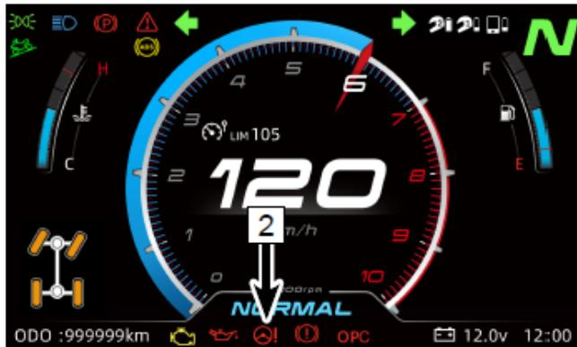
В случае неисправности усилителя рулевого управления обратитесь к авторизованному дилеру для диагностики и ремонта. Как только неисправность будет устранена, индикатор погаснет на панели приборов.
